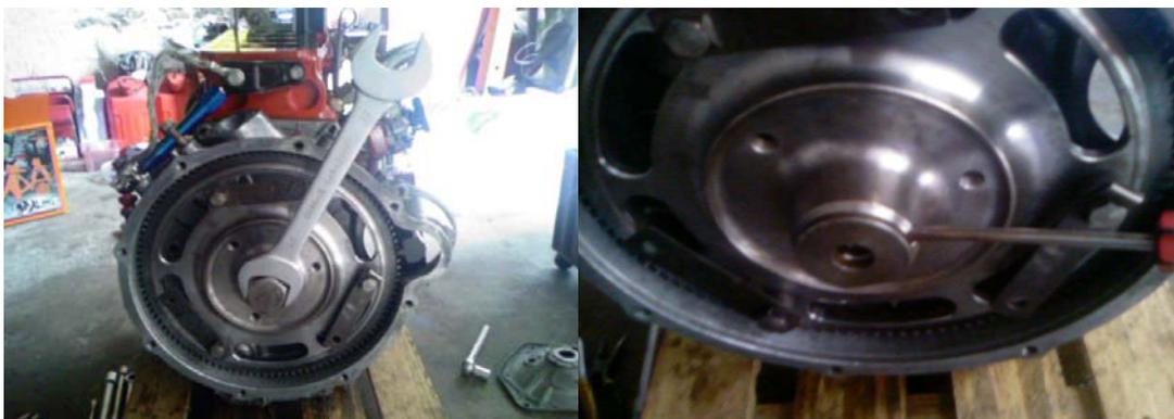
Bloquer le volant moteur avec l'outil adapté puis déposer l'écrou de la queue de vilebrequin & rondelle.
