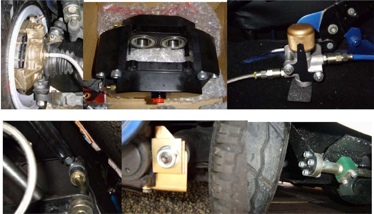
Des tirants moteurs sur rotules permettant de fixer solidement le bloc au berceau.
