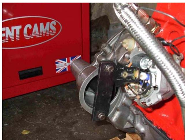
Moteur pigé à  $106^\circ$ , on tournera le vernier de réglage jusqu'à obtenir une levée maximale de la tige de culbuteur à l'admission au cylindre 1.
